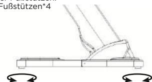
Vier verstellbare Fußstützen sorgen für Stabilität und Ebenheit der Liege. Stellen Sie nach dem Verschieben des Bettes die Fußpolster so ein, dass sie vollen Bodenkontakt haben, damit das Bett stabil steht.
